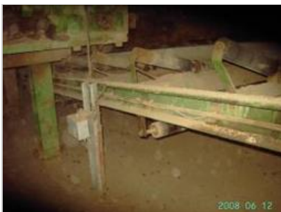
Rol opgaande zandband onvoldoende afgeschermd
