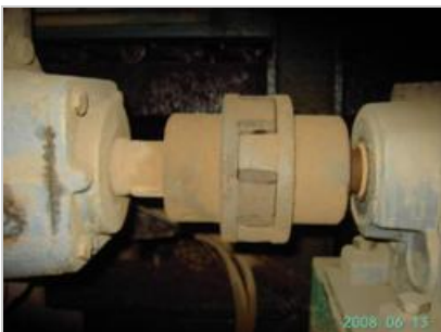
Afscherming bij draaiende as kleibeschikker ontbreekt
