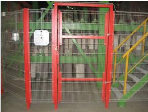
Toegang tot grijper die lege cassettes oppakt afgeschermd met hekwerk en contactschakelaar
