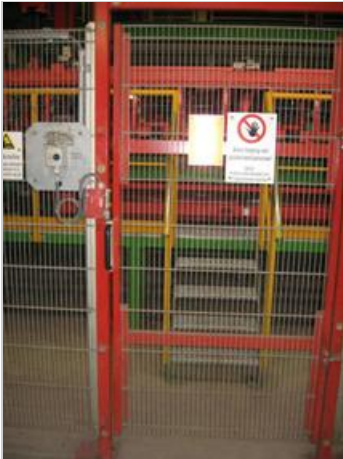
Toegang tot stapelaar beveiligd met hekwerk met contactschakelaar.
