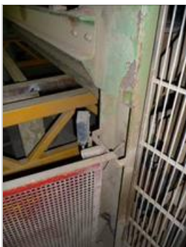
Rol opgaande zandband onvoldoende afgeschermd
