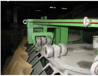
Beknellingsgevaar onder rollers carroussel.
