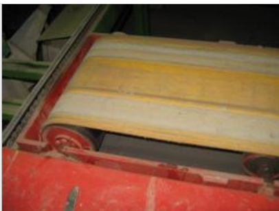
Aandrijfrol onvoldoende afgeschermd
