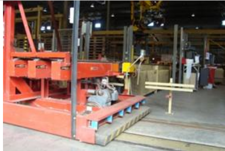
Traversewagen met aanstootrand en (blauwe) lichtsensoren
