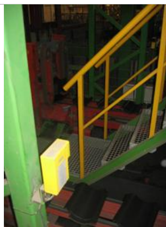
Toegang tot verenkelaar beveiligd met sensoren voor detectie
