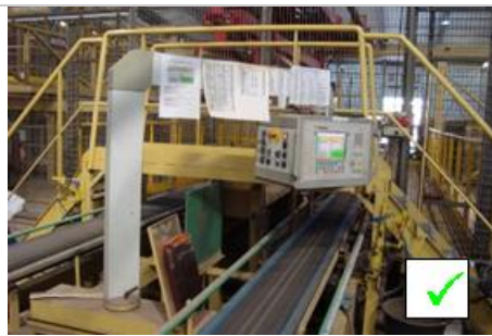
Eisen aan looppaden rond machine: via een veilige overloop kan men naar de ander zijde van een machinelijn komen zonder te klimmen of onderdoor te kruipen
