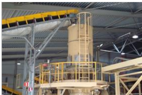
Overstortpunt met bordessen voor veilig werken op hoogte
