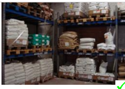
Opslag grondstoffen in stelling op pallet. Doorstoten door de muur aan de achterzijde is niet mogelijk
