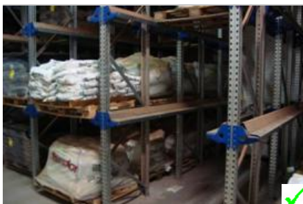
Stelling met geleideprofiel voor stabiel plaatsen van pallets
