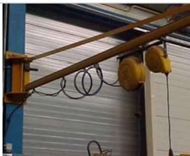
Zwenkarm om lucht en elektrciteit aan te hangen (geen snoeren op de vloer)
